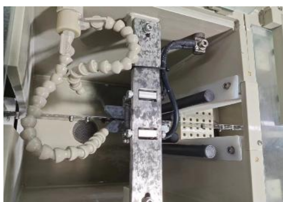
带电清洗，避免药水侵蚀产品
