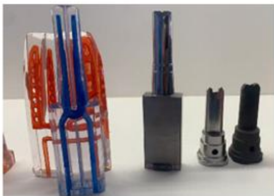
注塑模金属3D打印随形水路
